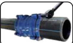
5 Una vez presentado el cople, apretar en forma secuencial los tornillos hasta un torque de 30 lbs/ft. Para fijar el anillo a la tubería de PEAD
